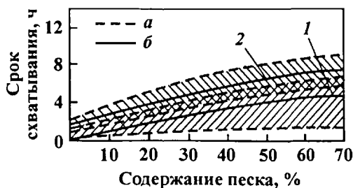
Рис. 16.13. Зависимость сроков схватывания шлакопесчаных растворов от содержания песка ( t = 150\text{ }^{\circ}\text{C} ; p = 50\text{ МПа} ): а - области применения начала и конца схватывания; б - усредненные значения; 1, 2 - соответственно начало и конец схватывания
