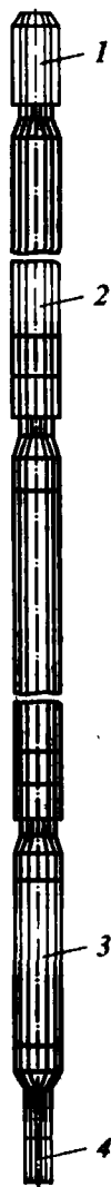
Рис. 10.16. Турбобур секционный шпindelный типа ТСША для бурения алмазными долотами: 1 - переводник к бурильным трубам; 2 - секция турбинная; 3 - секция шпindelная; 4 - переводник вала
